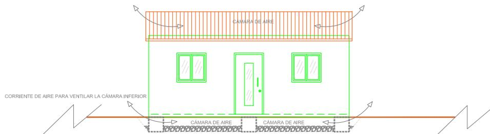
CORRIENTE DE AIRE PARA VENTILAR LA CÁMARA INFERIOR
